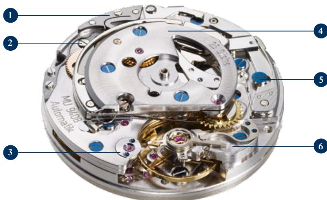
Funktionale und ästhetische Veredelungen bei Mühle-Glashütte: 1) Strichschliff; 2) Politur; 3) Kreisschliff; 4) Glashütter Sonnenschliff; 5) Gebläute Schrauben; 6) Perlage.
